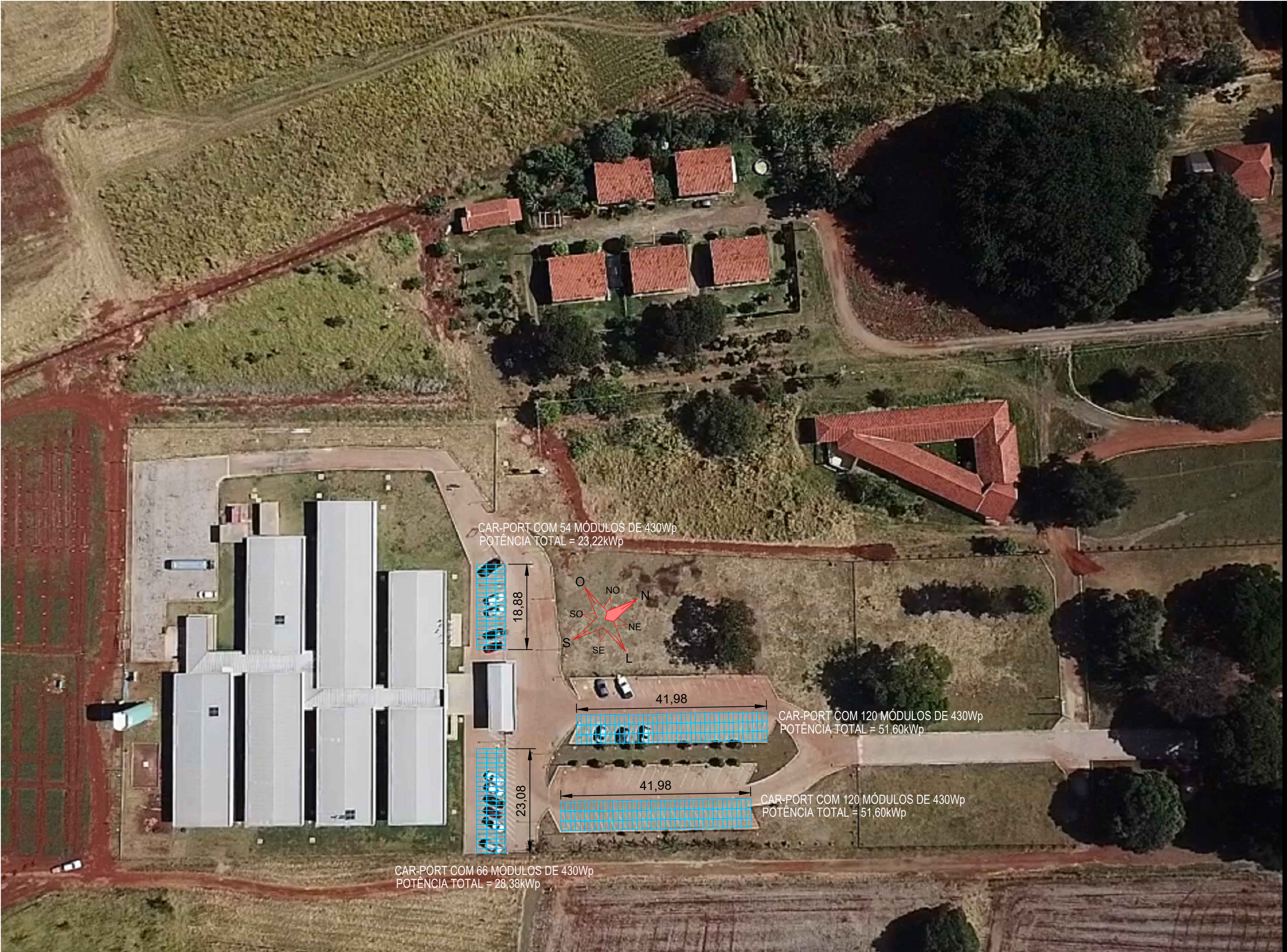
PLANTA - LOCAÇÃO DOS MÓDULOS (CAR-PORT - POTÊNCIA TOTAL 154,80kWp) SEM ESCALA
